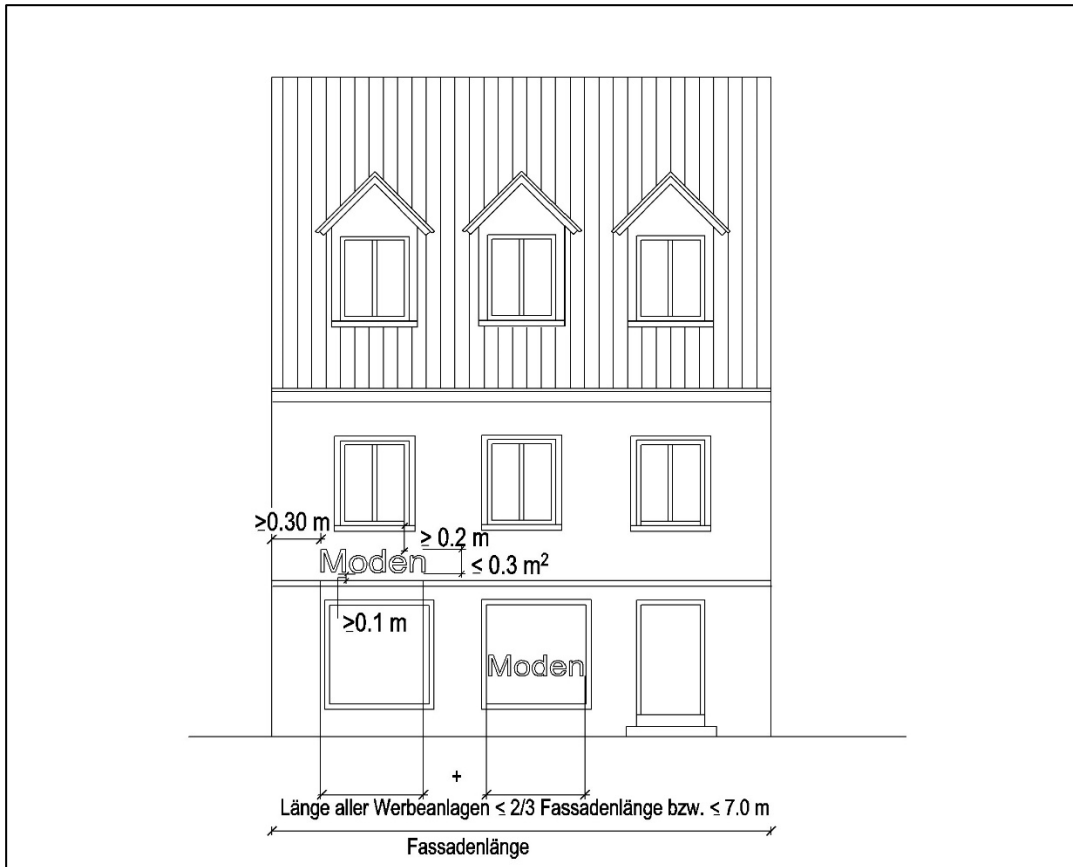
Erläuterungsskizze: Werbeanlagen, senkrecht zur Fassadenwand
