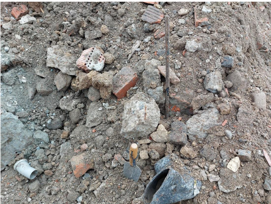
Abb. 2 Detail: Sandig-kiesige Auffüllung mit Beton- und Ziegelbruch; enthält Bewehrungsseisen, Schrott, Holz und Kunststoffreste < 1 %.
