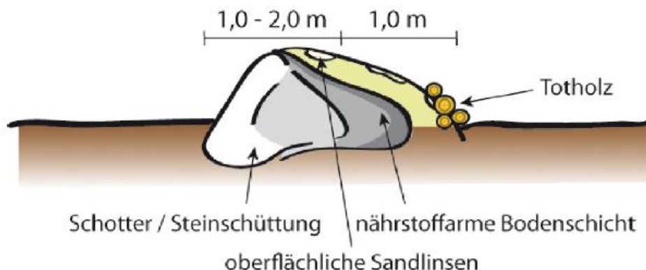
Abbildung 6: Schema zur Anlage von Stein-Totholz-Riegeln
