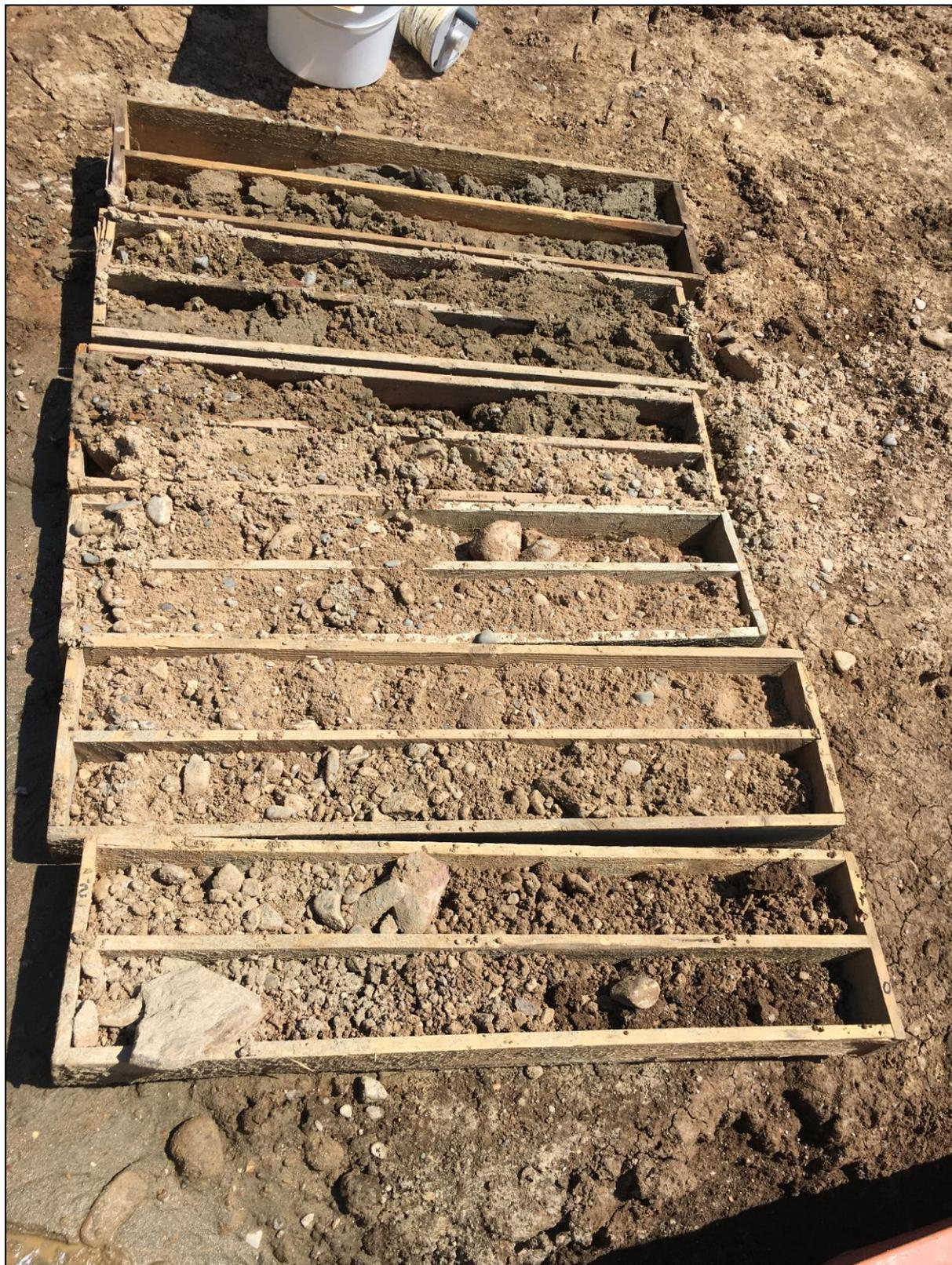
Bild 2: Bohrung GWM 1\_2021, Schichtaufbau (oben Kernkiste = 1. Bohrmeter)
