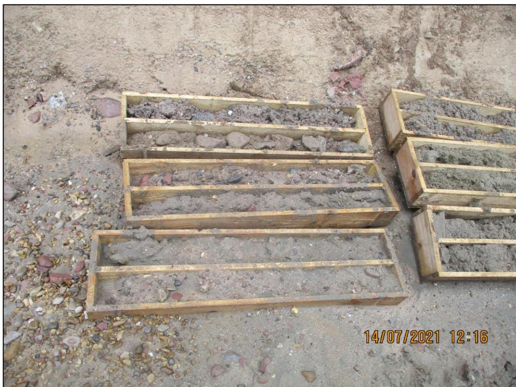
Bild 4: Bohrung GWM 2\_2021, Schichtaufbau (Kernkiste obenlinks = 1. Bohrmeter)
