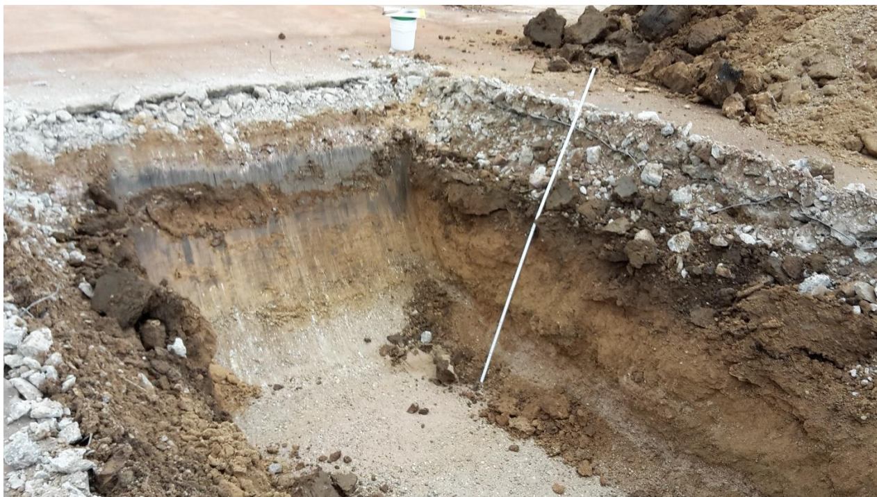
Abb. 1 Schürfgrube S8 mit allgemeinem Schichtenaufbau (Betonbodenplatte, Auffüllung, brauner Lehm, gelbe Schluffe + Feinsande, graue Sande + Kiese).
