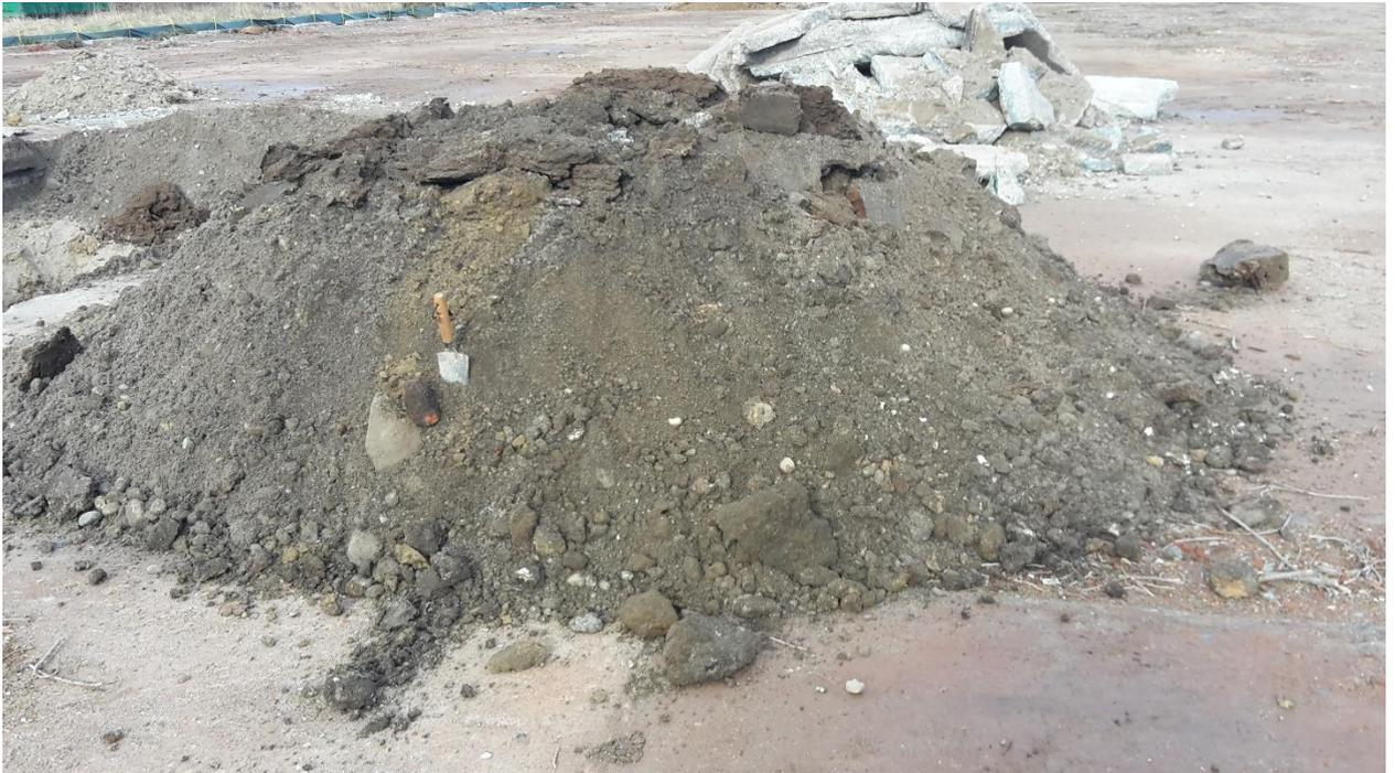
Abb.1 Haufwerk aus Schurf S 5: Auffüllung
