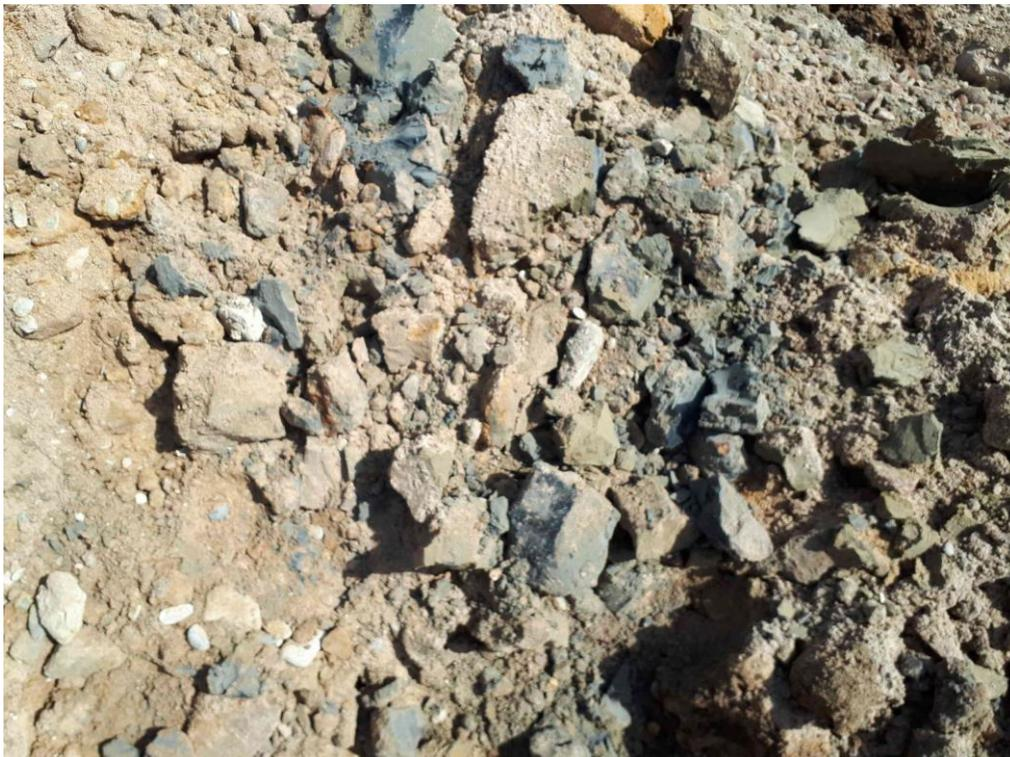
**Abbildung 2:** Blick auf das im Zuge des Baggerschurfes ausgehobene Material. Das graugrüne Material ist geruchlich auffällig. Das bräunliche Material weist keinen Geruch nach Diesel o.Ä. auf.
