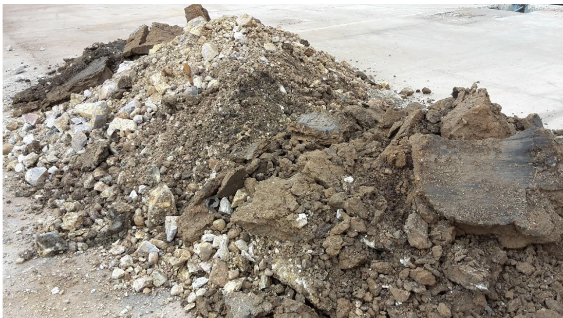
Abb. 2 Detailbild: Auffüllung aus Kies, Schotter und Lehm, bauschutthaltig.
