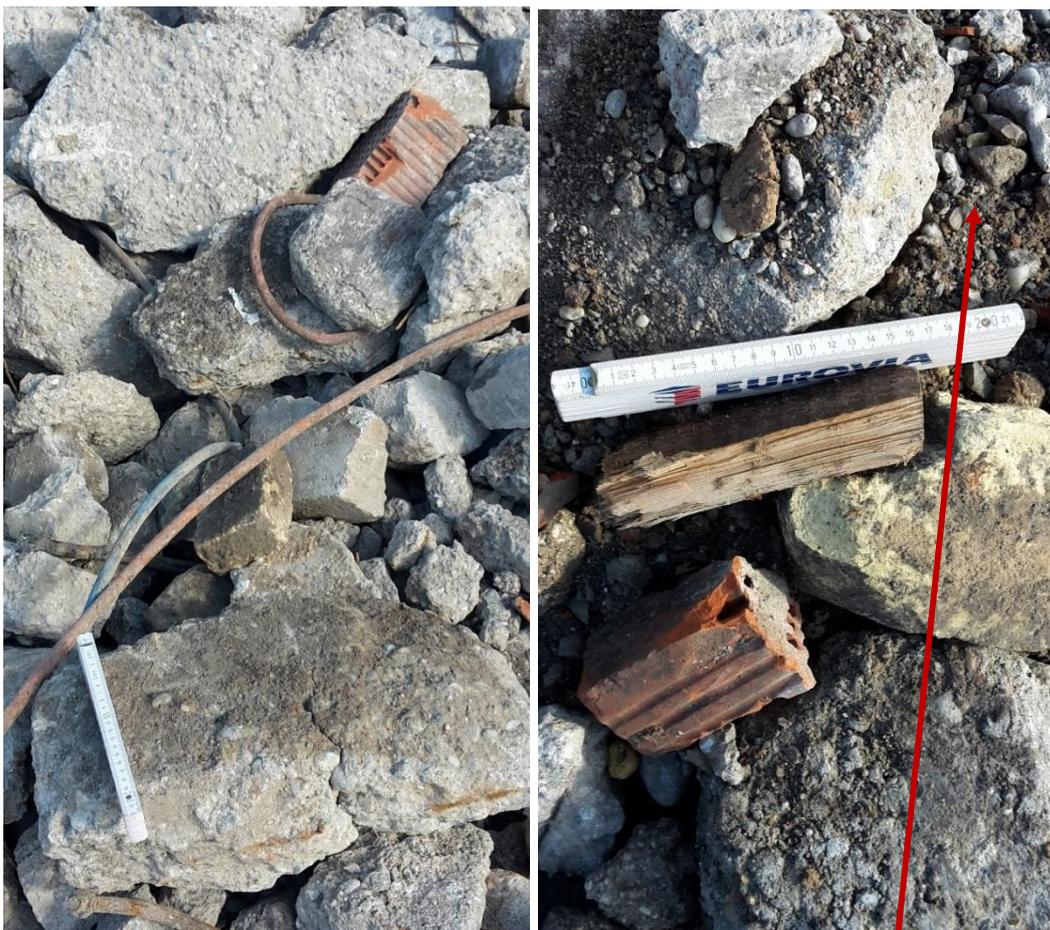
Abb. 3 Detail: Elektro-Kabel, Holz und Ziegebruch < 1 %.
